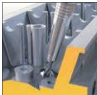
Barrenado en espacio angosto Drilling in tight space
