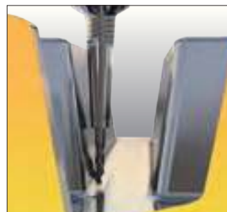
Fresado para acabado circular en espacios angostos Finishing with ball endmill in tight space
